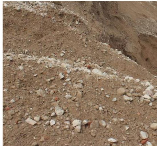
Kuva 5-10. Vasemmalla esimerkki rakenteeseen tiivistetystä "betonimurskeesta", joka ei täytä maarakentamisen materiaalivaatimuksia suuren palakoon, lajittuneisuuden sekä sen sisältämän jätteen vuoksi. Oikealla BEMII luokan laatuvaatimukset täyttävää betonimursketta. (Uusiomaarakentaminen 2017)
